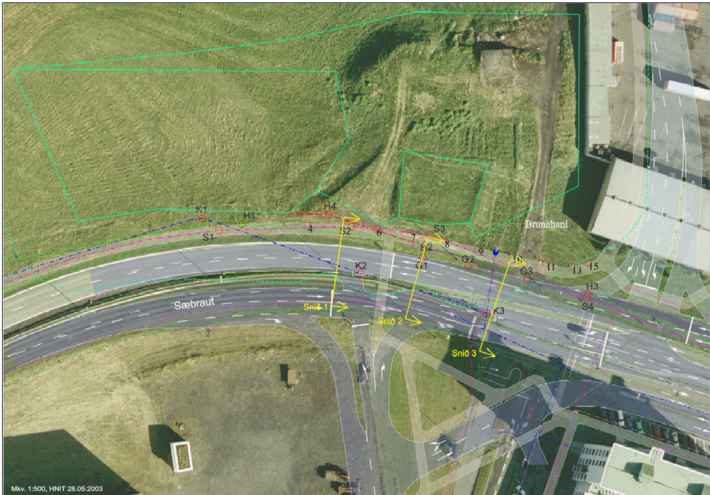
Mynd 17. Grunnmynd af væntanlegum framkvæmdum, gular línur sýna staðsetningu sniða 1-3, grænar útlínur fornleifa og 20m verndunarlínu, rauðar, dökkblár, bleikar og skærgænar sýna leiðslur á svæðinu.
